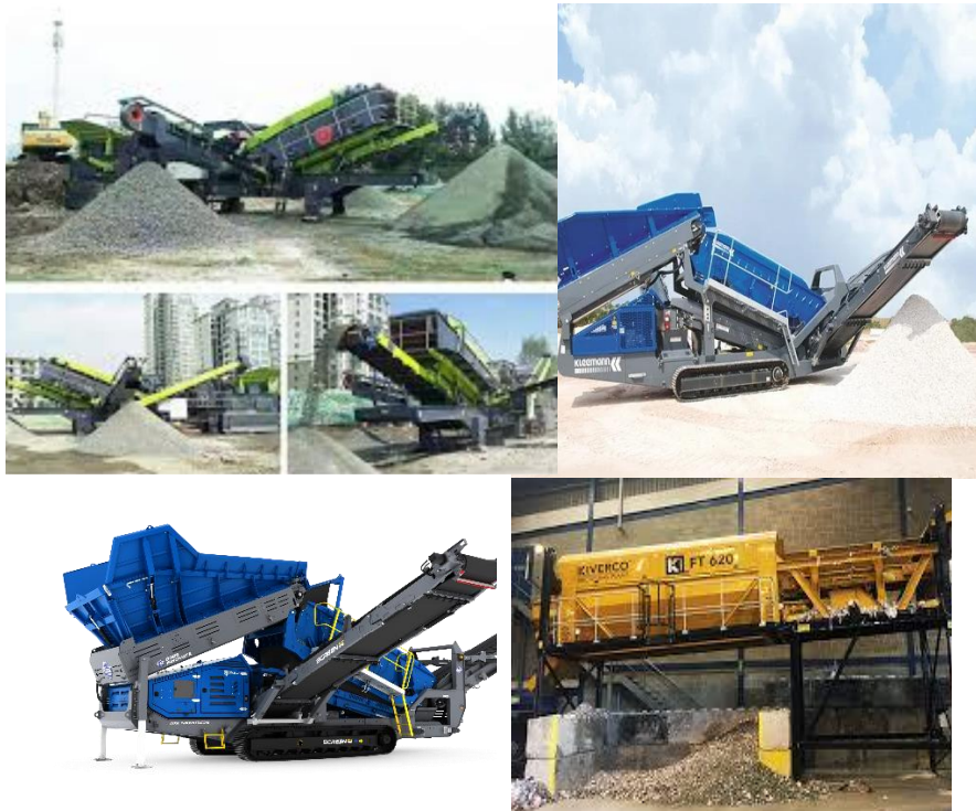
شکل ۲- تجهیزات مورد استفاده در سایت‌های سیار بازیافت
